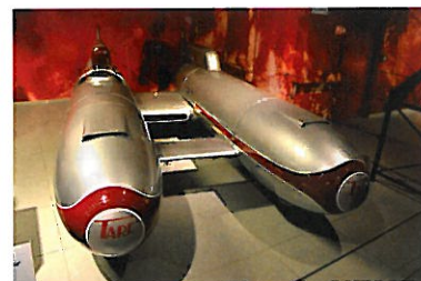
Italcorsa/Tarfi II (1951) Bisiluru (dvojitě torpédo) zkonstruoval závodník a inženýr Piero Taruffi. První generace poháněná motorem 0,5 l vytvořila šest světových rych- lostních rekordů. Druhá generace Tarfi II (1,7 l Maserati; 290 k) se při letmém kilome- tru a letmé míli téměř přiblížila 300 km/h. Další vytrvalostní rekordy ustavili v Montlhéry a na Monze
