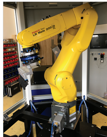
Základ buňky HXG tvoří centrální mechanismus nejčastěji ve tvaru hexagonu, v němž je umístěn šestiosý robot.
